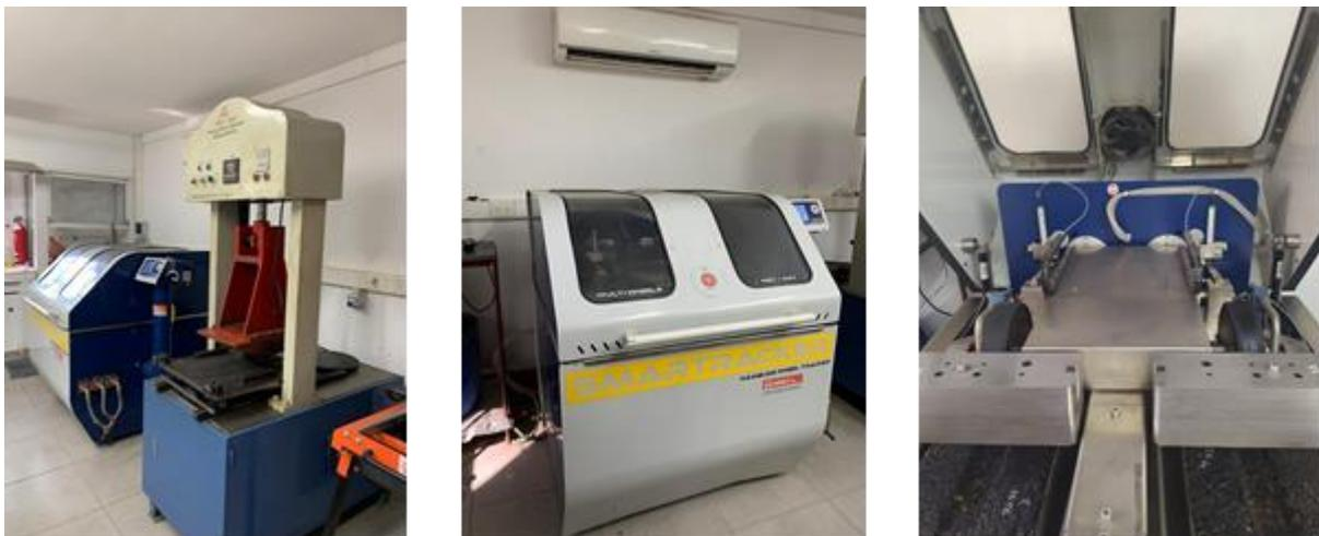
Figura 1. Equipo de Ensayo de Hamburgo
