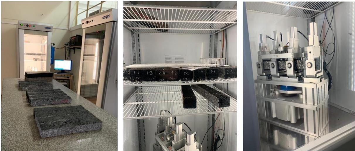
Figura 3. Vigas y equipo para medida de resistencia a fatiga en 4 puntos
